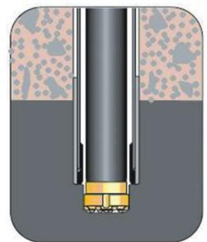
1、开始工作时，扩孔套打开，成孔范围扩大，带动管靴和根管向下跟进。
