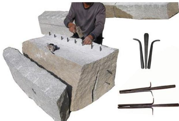
劈石器是一种实用、低成本的矿岩二次破碎设备，它是利用楔块原理来设计的——在最狭窄的孔中能够释放出极大的分裂力，使物体能够按照预定的方向裂开。
